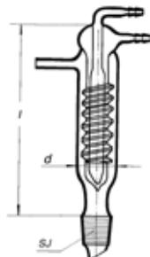
Chladič šroubový podle Friedrichse, s bočním přívodem, s NZ
