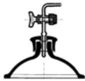
Víko exsikátoru s plastovým hmatníkem a skleněným kohoutem
