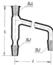
Přestupník s NZ 14/23 pro teploměr
