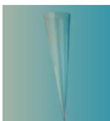
Válec sedimentační podle Imhoffa s uzavřenou špičkou
