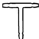
Rourka spojovací „T“ s olivkami
