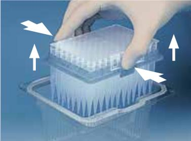
Apretar el elemento auxiliar para traslado a lo largo, mantenerlo presionado y extraer la placa soporte. Procurar que las correas de sujeción del elemento auxiliar para traslado estén en la posición correcta.
